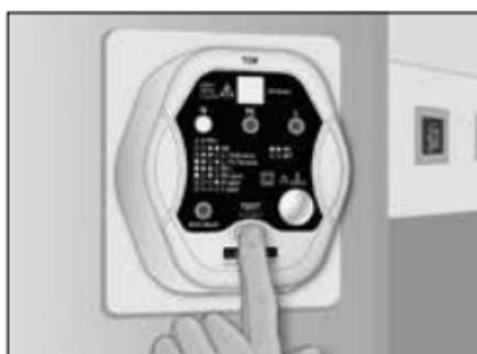
3. Når man trykker på knappen „TEST“ (i 3 sek.), udløses den forankoblede FI/RCD-beskyttelsesafbryder.
