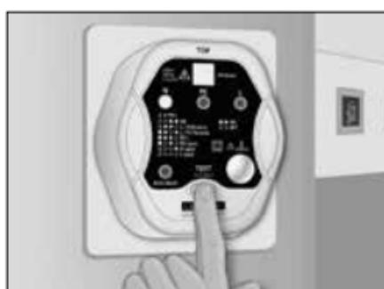
3. Premendo il tasto „TEST“ (3 sec.) interviene l'interruttore di sicurezza per cortocircuiti di terra/interruttore differenziale.
