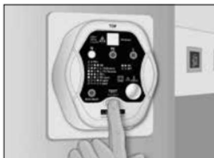
3. Pulsando el botón „TEST“ (3 seg.) se activa el interruptor de protección FI/RCD preconectado.
