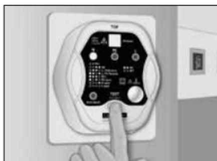
3. Il faut appuyer sur la touche « TEST » (pendant 3 secondes) pour déclencher le disjoncteur de protection FI/disjoncteur différentiel couplé en amont.
