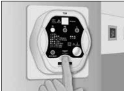
3. Eteen kytketty FI/RCD-vikavirtasuojakytkin laukaistaan painamalla TEST-näppäintä (3 s).
