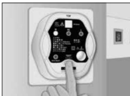
3. Durch Drücken der „TEST“ Taste (3 Sek.) wird der vorgeschaltete FI/RCD-Schutzschalter ausgelöst.
