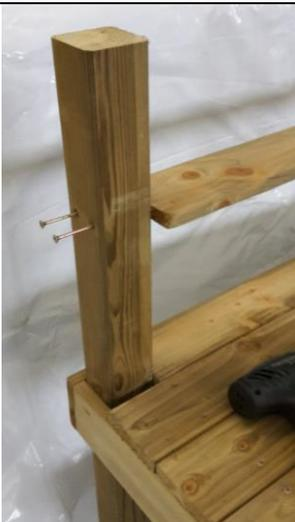
Seitliche Montage des Regals mit 4 Schrauben Pos A (2 links und 2 rechts)
