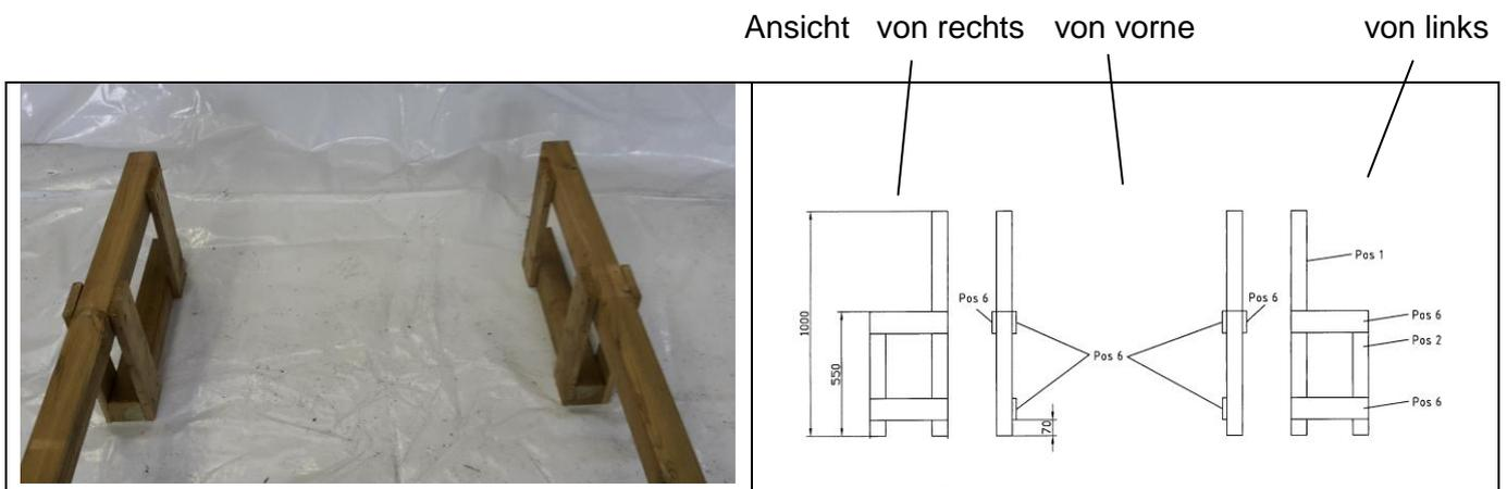
**Schritt 2:** Sie benötigen 2 Stk Pos 4 / und Schrauben A
