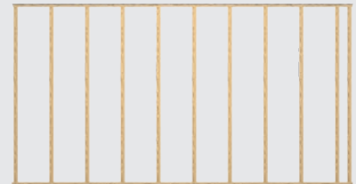
Achsabstand Unterkonstruktion max. 500 mm
